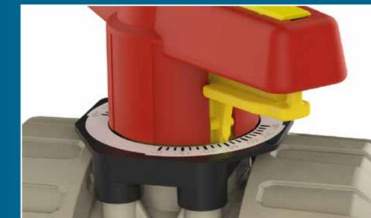
Für eine verdrehsichere Positionierung der Kugel im Durchfluss. Wiederholgenaue Einstellung der Durchflussmenge durch 5° Rasterung und Skalierung.
