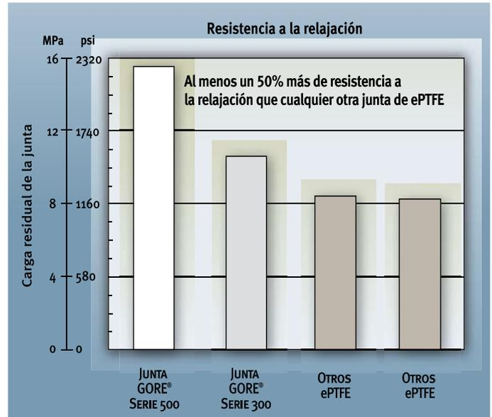
Los datos de resistencia a la relajación se basan en la norma EN13555 utilizando junta de 15 mm x 3 mm configurada en un anillo de 150 mm con unión en bisel. Los valores  $P_{QR}$  han sido obtenidos a una carga inicial de 30 MPa y 150 °C.
