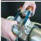
La llave con el soporte, actúa como efecto palanca: Con una mano sujetamos el soporte con la llave, y a la vez colocaremos el puente de apriete. Con la otra mano anclaremos la parte superior de la pieza, para efectuar el cierre de la abrazadera.
