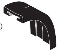
El diseño de sus bordes permite una compresión **contra la superficie curva de los tubos (no contra las ranuras)**. En la figura se aprecia la colocación de la junta sobre la superficie de los tubos a unir.
