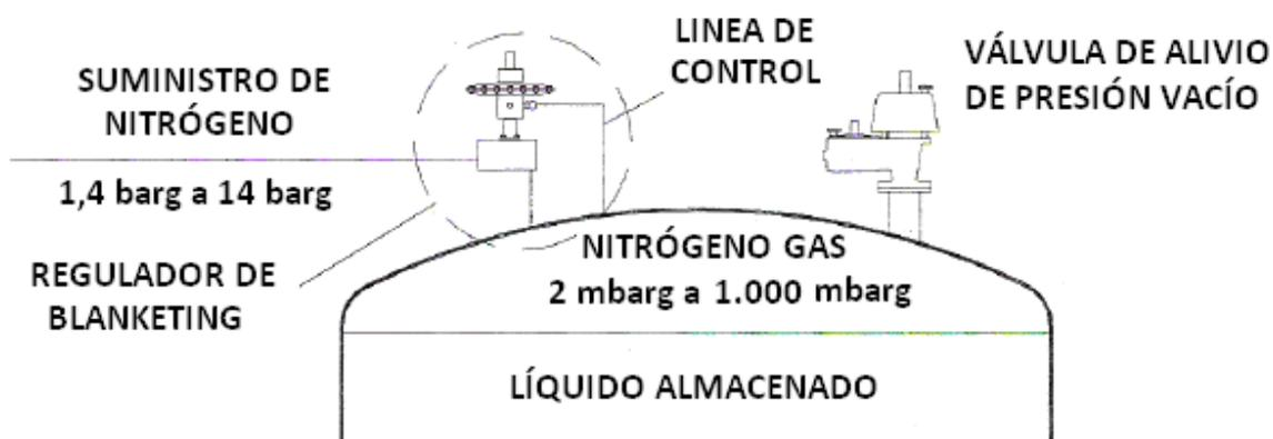
Figura 1. Esquema tanque con válvula reguladora de Blanketing
