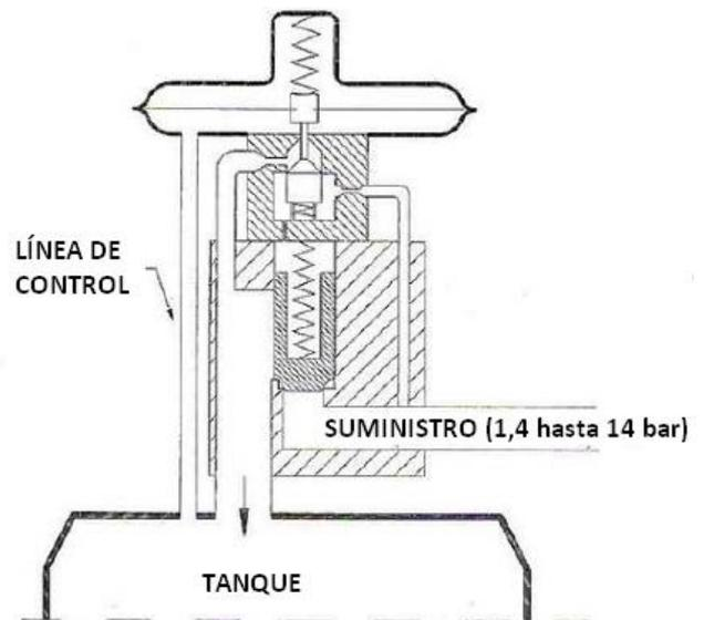
Figura 2. Posición cerrada: la presión del tanque es superior a la de tarado.
