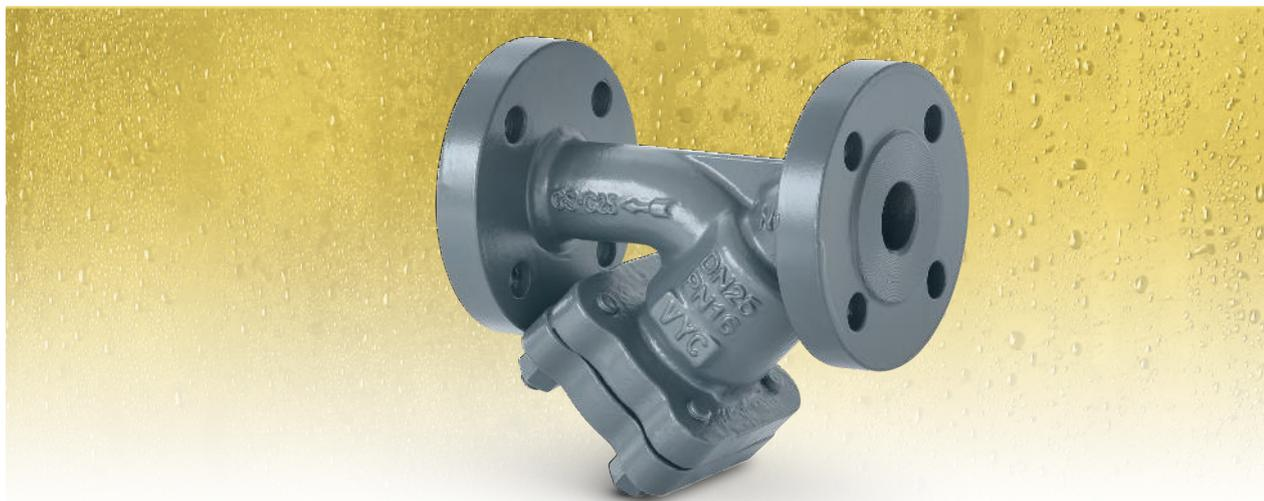
Permite el filtrado y acumulación de las partículas sólidas en suspensión, que arrastran los fluidos, para su posterior evacuación. Así protegemos y evitamos los daños colaterales en equipos de control y regulación aguas abajo del filtro.
