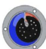
3- La entrada del líquido va llenando de forma progresiva la cámara de medida de entrada (rojo) a la vez que se empieza a vaciar la cámara de salida (azul). A la mitad del ciclo (punto de la figura), las dos cámaras tienen el mismo tamaño.
