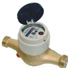
De manera opcional, el contador 405S puede llevar un cabezal extraíble sellada con un tapón de plástico. Este cabezal permite abrir el contador para cambiar y limpiar fácilmente la pieza de medición.
