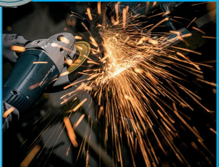
Los abrasivos rígidos son utensilios de particular eficacia para operaciones de corte y de desbaste. La gama TAF, con el fin de satisfacer las máximas exigencias de uso, se divide en dos series:
