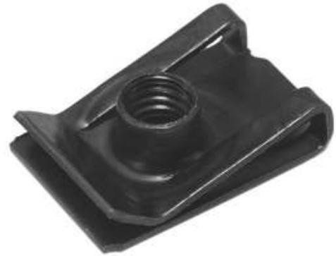
La tuerca rápida de seguridad universal TRT es un elemento de fijación compuesto de dos pestañas con un posicionamiento de apuntado exterior que proporciona una doble presión elástica. En el centro de la pestaña superior brota un cilindro hueco con múltiples filetes de rosca que tratados al par preciso de apriete pueden generar una óptima resistencia de ensamblaje y fijación.
