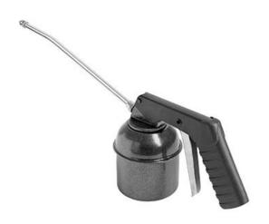
Aceitera para uso industrial construida íntegramente en metal. Cuerpo de bomba con mecanismo de doble válvula de alta presión (40 bar) y filtro de aspiración. Accionamiento mediante gatillo acoplado a empuñadura ergonómica de tipo pistola. Salida rígida acodada de 200 mm con boquilla. Modelo de depósito de 300 g.
