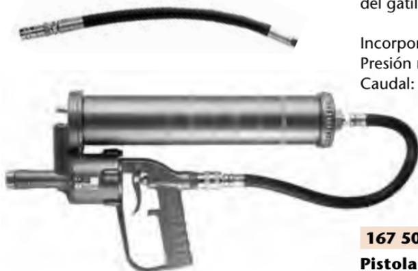
Pistola neumática de engrase con ratio de presión de entrega 60:1. Depósito de grasa 1.000 cc de capacidad con émbolo neumático para alimentación de grasa, ideal para grasas duras o con bajas temperaturas. Carga del depósito a granel o con dispensador. Motor neumático de bajo consumo de aire comprimido. Control de emboladas por pulsación del gatillo.
